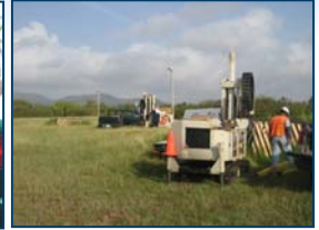
SWMU 74 – Varios equipos de excavación están tomando muestras del subsuelo
